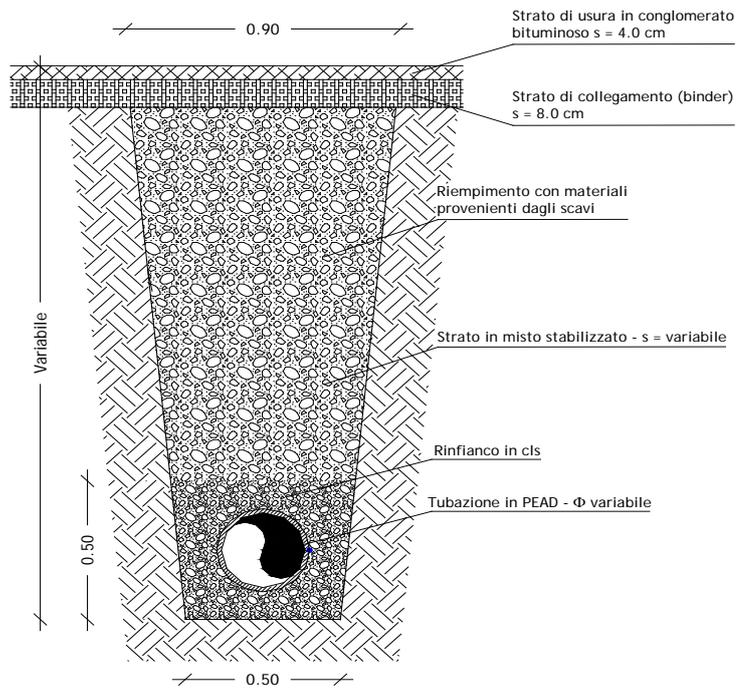
Il riempimento della restante altezza della trincea fino al piano di campagna viene effettuato con lo stesso materiale di scavo spurgato di elementi di grosse dimensioni e residui vari.
